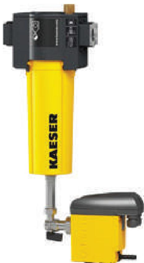
Per la rimozione della condensa alla mandata del compressore. Grado di separazione fino al 99% - su una gamma di potenza tra il 20 e il 100% del volume: stabile e con un calo di pressione inferiore a 0,1 bar. Di serie con scaricatore di condensa ECO-DRAIN 31 (Vario). L'essiccazione a valle e la filtrazione dell'aria compressa sono sempre consigliate.
